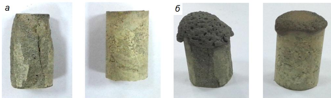
Рис. 1. Образцы серного бетона (а), результаты эксперимента (б)
